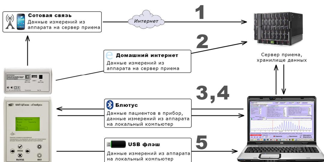
Рис.74 Каналы передачи данных на локальный и удаленный компьютер
